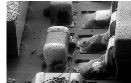
A bajo aumento SE, imagen de un PCB con SMD en el modo de VP (16 kV y 36 Pa presión de la cámara). Es cierto, sin imágenes de SE la destrucción del PCB sería inminente.
